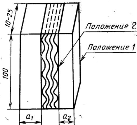
3.2. Образец устанавливают на предметном столе микроскопа таким образом, чтобы поверхность среза была обращена к тубусу.
