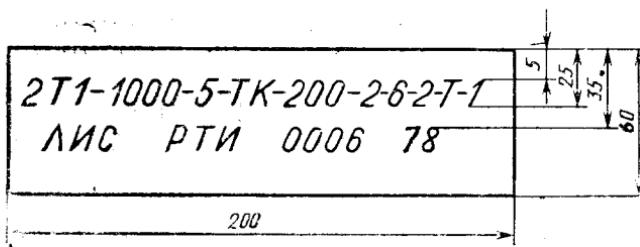
Буквенные и цифровые индексы обозначают ленту № 0006, типа 2, теплостойкую 2T1 шириной 1000 мм из пяти прокладок ткани TK-200—2, с обкладками из резины Т-1 толщиной 6 и 2 мм, изготовленную Лисичанским заводом РТИ в 1978 г.
